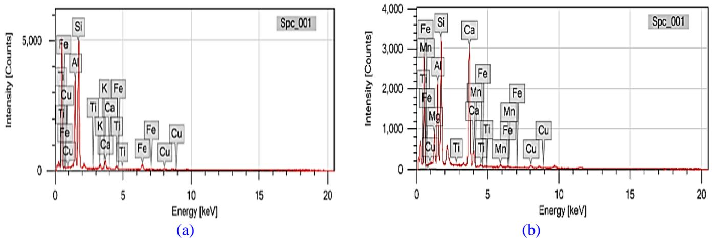
**Figure 1:** EDS for a) fly ash b) Alccofine 1203.
